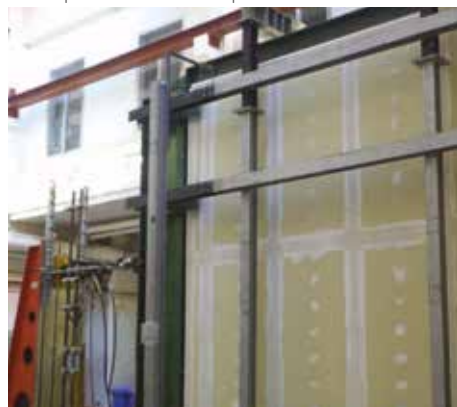
Test quasi-statico nel piano
